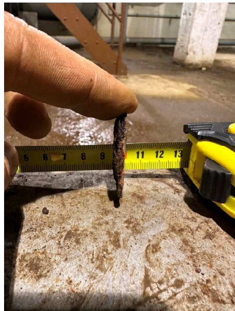
Foto 34 – Korozní produkty v tl. 5 mm
