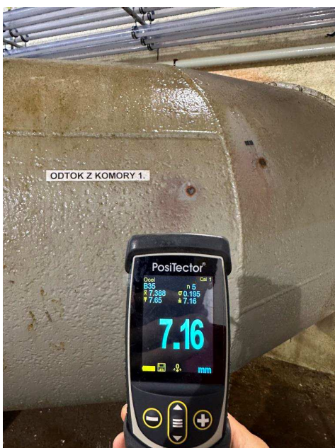
Foto 13 a 14 – Měření tloušťky stěny ocelového potrubí
